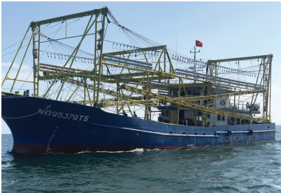
Mô hình lắp đặt đèn LED đánh cá tại Đà Nẵng
