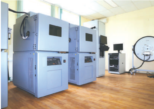
Hệ thống thử nghiệm dự đoán tuổi thọ LED LM-80
