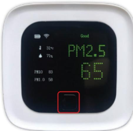
Ấn phím nguồn 1 lần để bật/tắt màn hình thiết bị. Khi tắt màn hình bằng ấn 1 lần thì cảm biến vẫn hoạt động và gửi các thông số lên ứng dụng (Chỉ tắt LED báo và màn hình).
